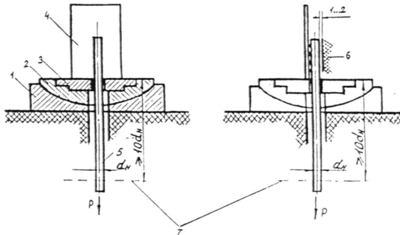
1 — сферическая опора; 2 — сферический вкладыш; 3 — сменное опорное кольцо; 4 - плоский элемент закладного изделия; 5 — анкерный стержень; 6 - упор, препятствующий изгибу образца; 7 — граница закрепления в захватах разрывной машины;  $d_n$  — номинальный диаметр анкерного стержня; P - испытательная нагрузка
