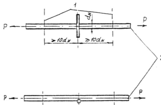
1 — граница закрепления в захватах разрывной машины;
